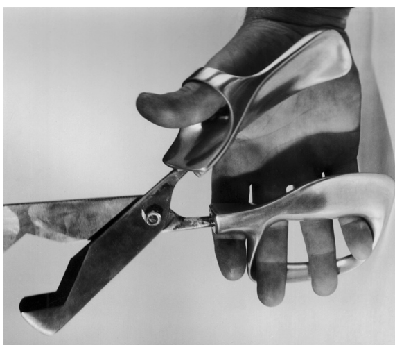
Zdeněk Kovář, Nůžky pro skláře (řešení téhož nástroje), původní verze společně s anatomicky upraveným řešením odpovídajícím fyziologii ruky, 1964
